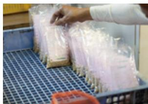
持ち込まれたお米は計量中にサンプルを取り、生産者ごとに品質検査をします。機械で自動的にデータ化すると同時に、検査員の目でも厳しくチェックしています。
