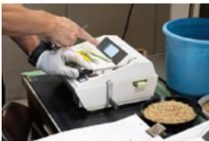
荷受けライン上に自動水分計測装置を設置して、お米の水分と重量を自動的に計測。乾燥機に通して規定の水分量14.5%に調整し、常にチェックしています。
