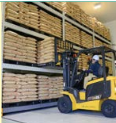
倉庫には玄米30kg紙袋をパレット単位で保管し、電動操作で棚を動かせる。入出庫時にはパレットごとリフトに積めるため、人力の作業が不要になった
