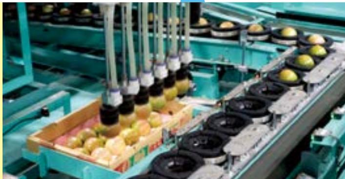
中国地方最大級を誇るトマト選果場。機械選別装置(カラーソーター)の機能性を向上し、着色判定・階級判定の選果精度を高め、選果むらを解消。製品予冷では冷蔵機と冷凍機の計10台で予冷温度を保ち、コールドチェーン(低温物流体系)を強化することで、消費者により新鮮な状態で「桃太郎トマト」を届け、スーパーでの棚もちも向上し食品ロス軽減にもつなげています。
